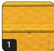
Capa exterior fabricada en polietileno clorosulfonado
